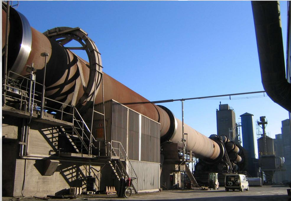
Oben links und in der Bildmitte sind die fertig gedrehten Laufbahnringe zu erkennen.
