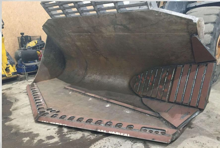
Fertig angeschweißte Verschleißschutzplatten an Radladerschaufel
