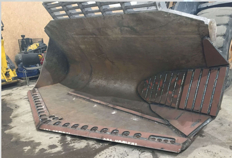
Ferdig innsveist slitestål på hjullasterskuffe
